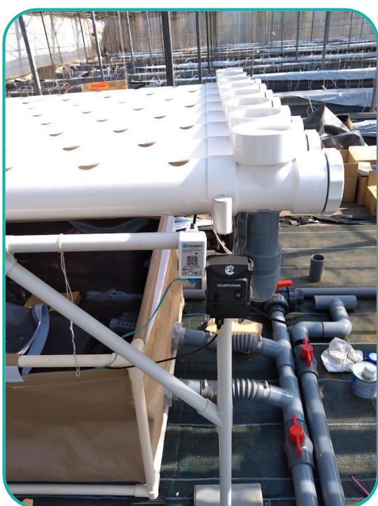
水槽での設置例 センサー部を水槽に入れて水温を計測
